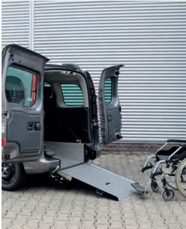
Bei ausgeklappter Rampe ist das Fahrzeug mit dem Rollstuhl befahrbar.
