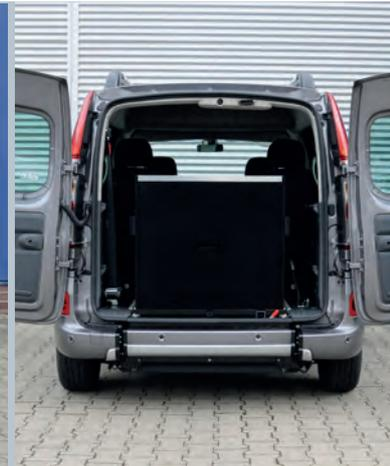
Abfahrbereites Fahrzeug mit eingeklappter Rampe.
